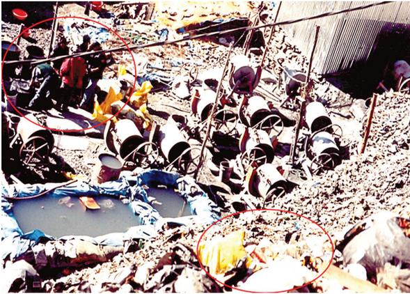
**Figura 3.** Tecnificación artesanal, uso de molinos eléctricos, mayor contaminación (izquierda). Uso de cianuro en minería informal, sin control (derecha).
